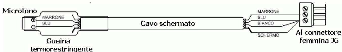
Il microfono deve essere installato all'interno della cabina, in una posizione che assicuri una buona ricezione della voce, fissandolo eventualmente con un supporto; in particolare, porre attenzione al fatto che la capsula microfonica non sia a contatto con parti metalliche, ma sia sospesa in aria, onde pregiudicarne il buon funzionamento.
